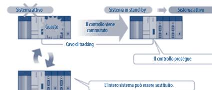
In caso di guasto il controllo viene commutato sul sistema in standby in soli 22 ms.
